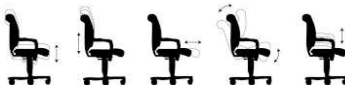
Obrázek č. 1 Nastavitelné parametry sedadla (Gilbertová & Matoušek, 2002)
